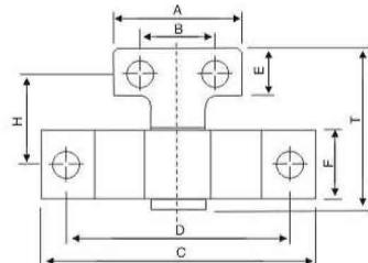
利用簡單之構造，可使用模具完全打開與密合，且裝置簡單互換性高。本裝置最適合三模板之針點射出 有拉斷料頭與脫模一次完全之功能。且採用高級合金鋼熱處理後研磨而成，採用進口彈簧，品質可靠。
